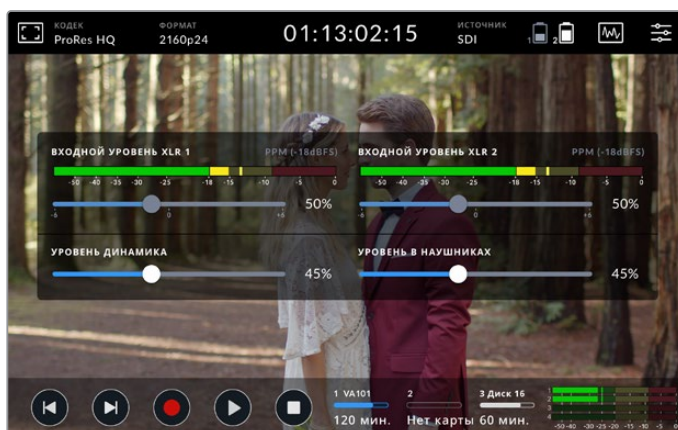
На Video Assist с 7-дюймовым экраном можно настроить уровень XLR-звука
