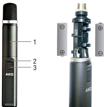
Figura 2: Inserimento delle batterie
